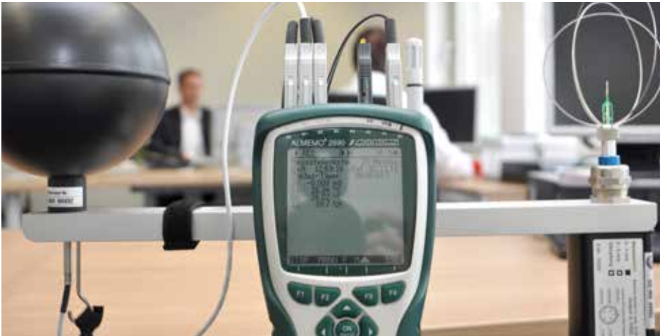
Experten von TÜV Hessen prüfen Leistungsparameter von raumlufttechnischen Anlagen, Bild: Matthias Voigt
