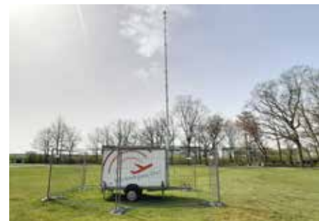
UNH-Lärmmessstation, Bild: UNH
